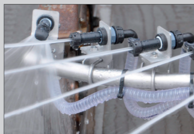
Hochgeschwindigkeitsstreuen mit Spratronic-Düsen. Streut bei allen Geschwindigkeiten bis zu 90 km/h.
