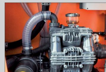
Logisch aufgebautes Solesystem mit Membranpumpe.
