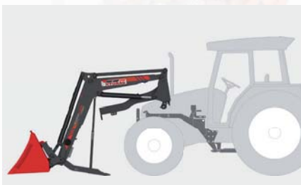
Komfortabler An- & Abbau (Serie 1000) Alle Bedienelemente (Konsolen-Verriegelung, Abstellstützen) sind komfortabel erreichbar.
