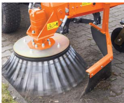
Flachdrahtbesen schneidet das Gras
