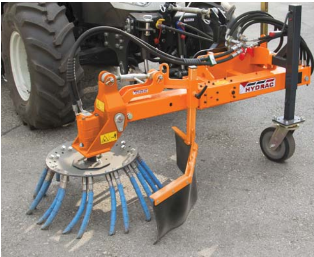
Grobstahlseilbesatz gegen hartnäckigen Besatz
