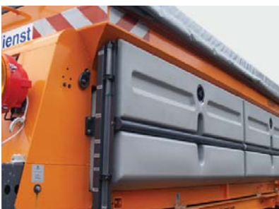
Seitentanks schließen mit der Außenkontur des Streuautomaten ab
