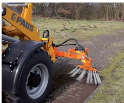
Hartnäckiges Gras wird bis zur Wurzel entfernt
