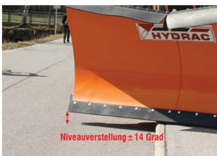
Hydraulische Niveaueinstellung z.B. zur Gehsteigreinigung
