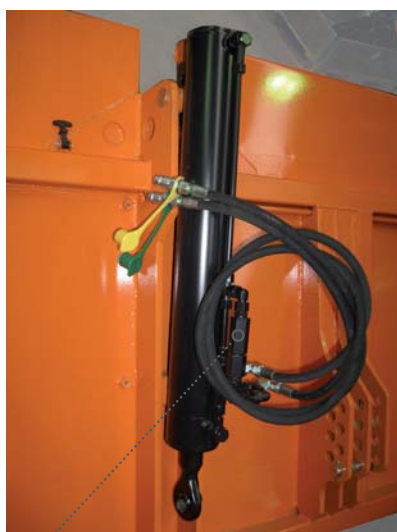
Hydraulischer Oberlenker mit ○ Rückschlagventil, für Selbstladeeinrichtung
