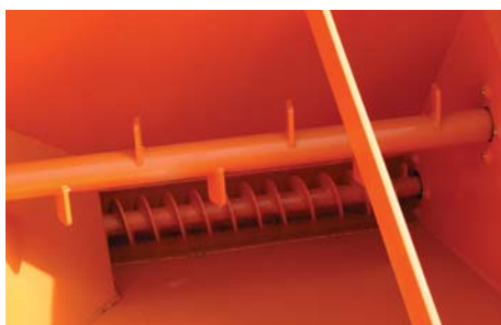
Verzinkte Rührwelle zum Auflockern des Streuguts
