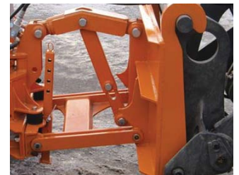
Ausgleichsstange für Schareinstellung und Querpendeleinrichtung
