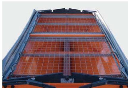
Sehr gute Befüllmöglichkeit des Streuautomaten, da das Planenklappdach zu 100 % öffnet
