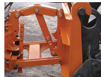
Barre de compensation pour réglage du soc et dispositif d'oscillation transversale
