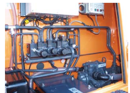
Compartiment hydraulique aisément accessible pour tous les organes de commande
