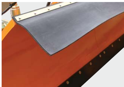
Défecteur anti-projections de neige en caoutchouc À trame tissu de renfort - porte-à-faux 250 mm, pour les neiges imprégnées de sel et très lourdes
