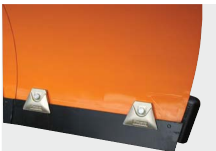
Système de serrage Dispositif de serrage rapide pour la fixation des bandes racleuses en acier et à structure en sandwich (sur demande seulement)
