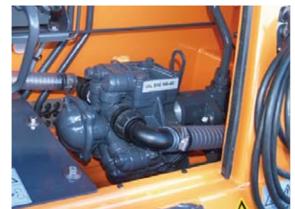
Système d'alimentation en liquide de construction conçu pour faciliter la maintenance, avec puissante pompe à membrane et piston
