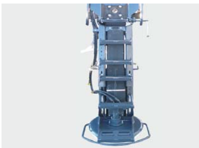
Répartiteur de matériau d'épandage avec échelle intégrée et chute fermée. (En option avec chambre de mélange)
