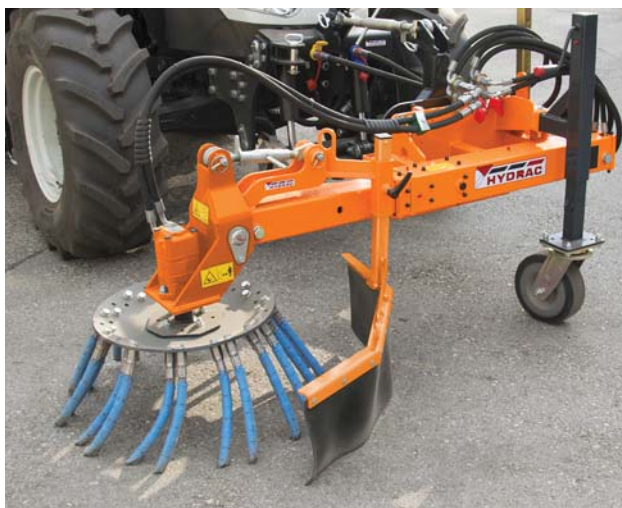
Gros filaments en acier contre les encrassements tenaces
