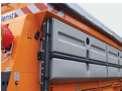
Réservoirs alignés avec le contour extérieur de l'épandeur automatique
