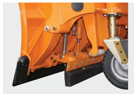
Lame arrière de bi-raclage avec relevage hydraulique garantissant la pleine rétraction de la lame arrière de bi-raclage. (voir page 7)
