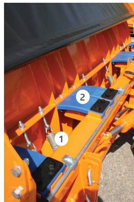
1 Ressorts réglables 2 Bras oscillants en plastique
