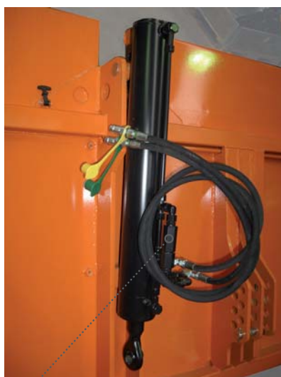
Troisième point hydraulique avec vanne anti-retour, Ø pour dispositif de chargement automatique
