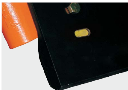
Lame de raclage Kombi - à structure en sandwich en acier, caoutchouc et corindon de haute qualité pour une grande durabilité
