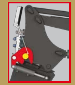
HYDRAULISCH von der Kabine aus VERRIEGELN...
