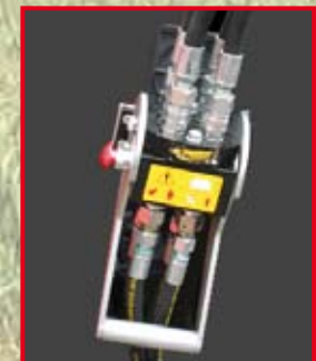
Multischlauchkuppler serienmäßig. Auf Wunsch mit integriertem Elektrostecker
