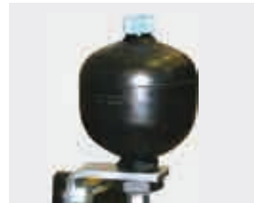
Schwingungsdämpfung SDF mechanisch schaltbar Der Schwingungsdämpfer absorbiert die auftretenden Schwingungen und reduziert Verschleiß an Frontlader und Traktor.
