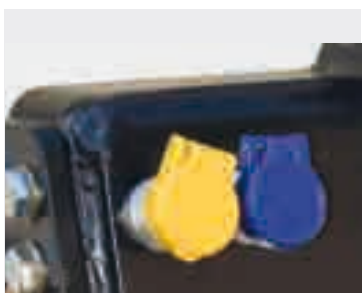
2 zusätzliche Hydraulikleitungen samt Steckkupplung-Muffen nach vorne (1 DW)
