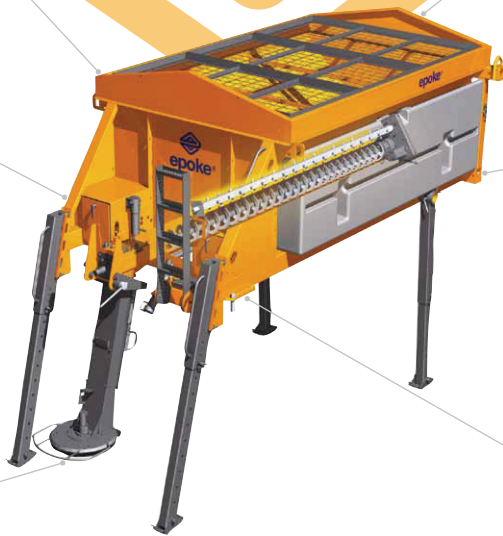
Dosierstern auf der Schnecke, das Streugut wird dem Streuschacht gleichmäßig zugeführt.
